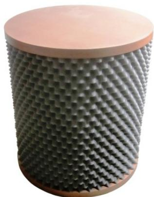
La **trappola** fonoassorbente **cilindrica** è costituita da coperchi in legno e struttura centrale in compensato curvabile rivestito da un materassino in poliuretano bugnato; la cavità interna è riempita con dischi in fibra di poliestere. La trappola è caratterizzata da eccellenti proprietà di fonoassorbimento che si attivano in particolare intorno a 500 Hz.
